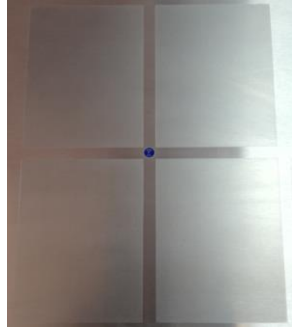
Figura 11.7 Duză pentru gaz în masa de lucru
