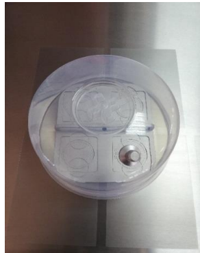
Figura 11.8 Hotă de gaz poziționată deasupra duzei de gaz
